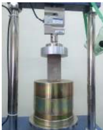
شکل ۷. دستگاه آزمایش فشاری تک محوری
