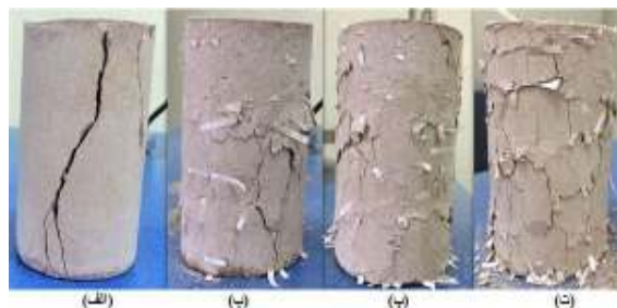
شکل ۲۵. نمونه‌های تثبیت شده با ۶ درصد سیمان، بدون الیاف (الف)، الیاف کیسه پلیمری (ب)، ۰/۵٪ الیاف کیسه پلیمری (پ) و ۱ درصد الیاف کیسه پلیمری (ت)
