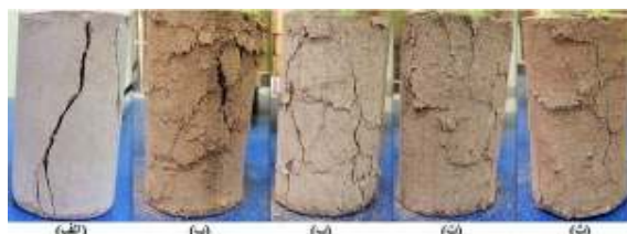
شکل ۳۴. نمونه های تثبیت شده با ۶ درصد سیمان، بدون الیاف تایر (الف)، ۰/۵٪ الیاف تایر (ب)، ۱٪ الیاف تایر (پ)، ۱/۵٪ الیاف تایر (ت) و ۲/۵٪ الیاف تایر (ث)
