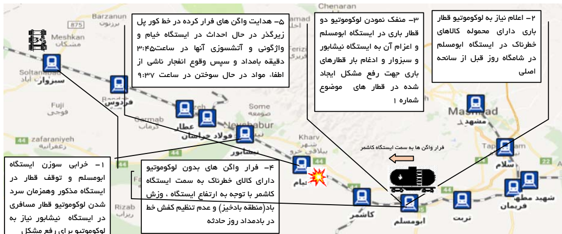
شکل ۳. نمایی از توالی رویدادها در زمان حادثه
