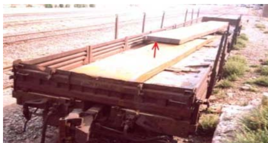
شکل ۵. یک طرفه بودن بار بر خلاف دستورالعمل حمل کالای خطرناک
