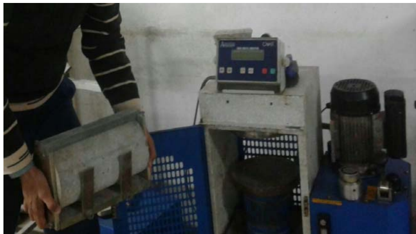
شکل ۳. نحوه انجام آزمایش مقاومت کششی
