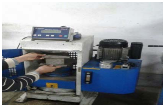
شکل ۵. نحوه انجام آزمایش مقاومت فشاری
