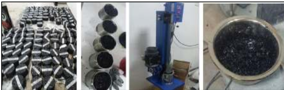
شکل ۴. مراحل ساخت و اختلاط مخلوط آسفالت متخلخل با مواد بازیافتی
