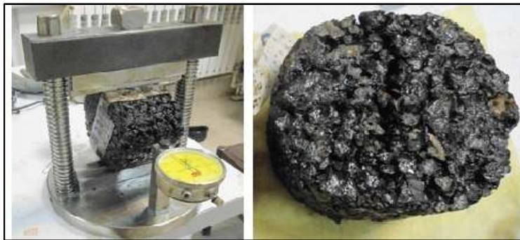
شکل ۶. فک و دستگاه آزمایش مقاومت کششی خشک و نمونه تخریب شده در این آزمایش
