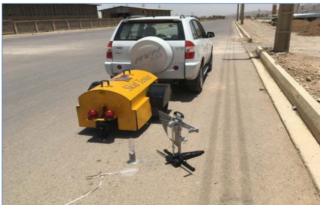
شکل ۳. آزمایش چرخ قفل شونده، پخش ماسه و پاندول انگلیسی در یکی از محورهای مورد بررسی
