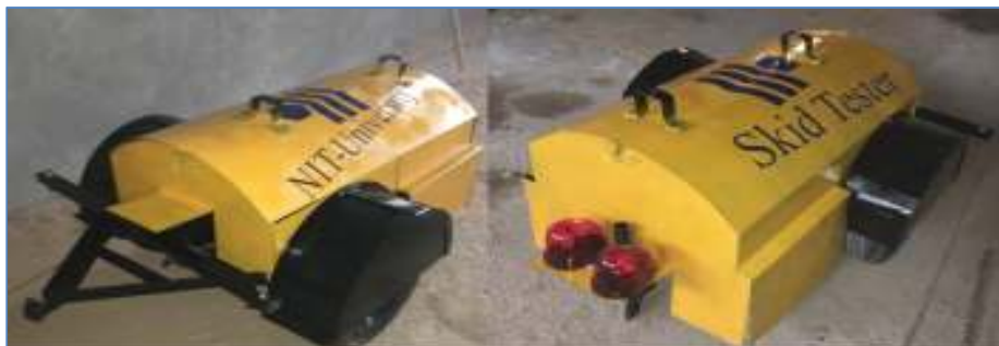
شکل ۱. نمای کلی دستگاه چرخ قفل شونده ایرانی
