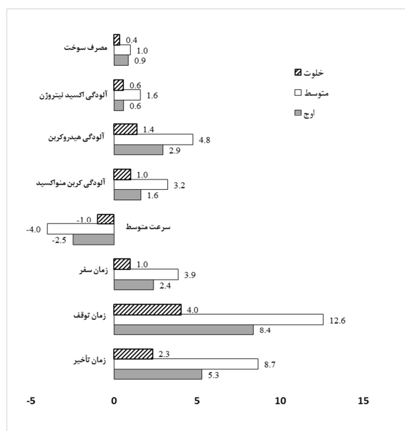
شکل ۹. درصد بهبود متغیرهای مختلف در دو نوع کنترل ثابت و ثابت هماهنگ در شریانی کاشانی
