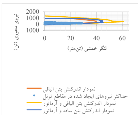
شکل ۱۵. مقایسه حالت‌های مختلف طراحی سگمنت پیش ساخته
