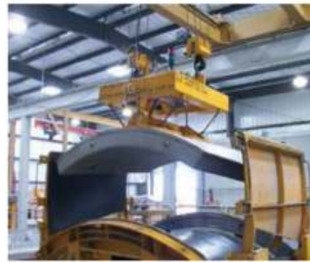
شکل ۲. قالب برداری در کارخانه
