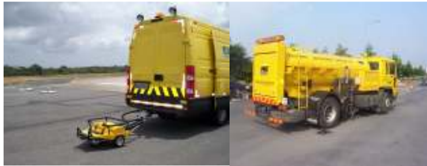
شکل ۵. سمت راست دستگاه SCRIM و سمت چپ دستگاه گریپ تستر را نشان می‌دهد.
