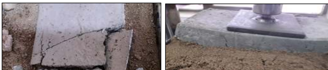
شکل ۳. نمونه آزمایشگاهی دال آزمایشگاهی بر بستر ماسه‌ای مرطوب ( P=300\text{kg} ) (راست).
