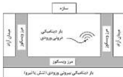
شکل ۵. نحوه بارگذاری و شرایط مرزی موجود در FLAC 3D برای پایه قابل انعطاف
