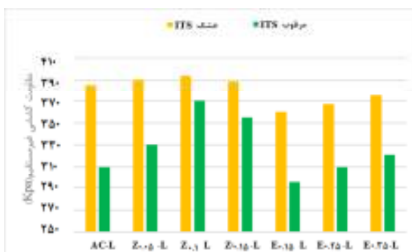
شکل ۲۲. مقاومت کشش غیرمستقیم برای دو حالت خشک و اشباع (Ameri and Zoormand, 2019)
