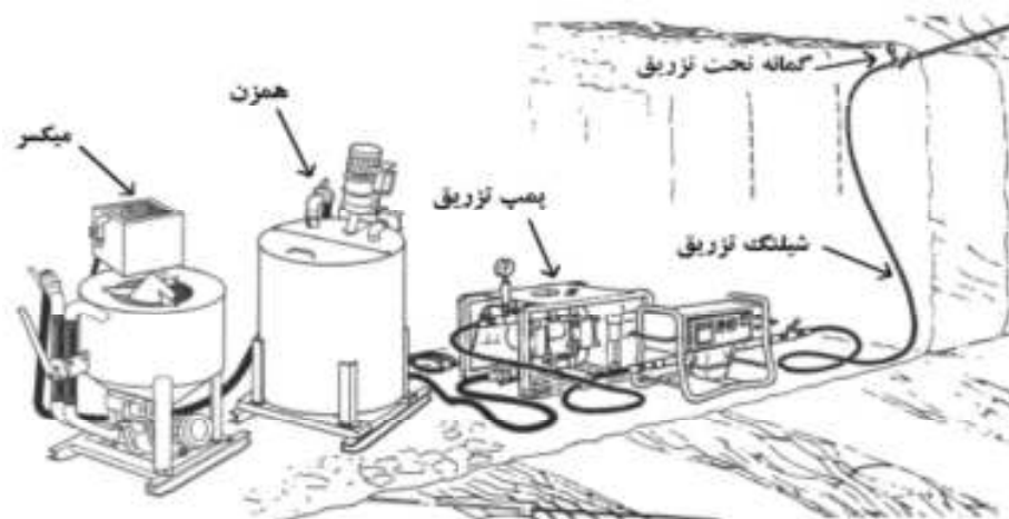
شکل ۱۲. ماشین آلات و تجهیزات مورد استفاده در عملیات تزریق
