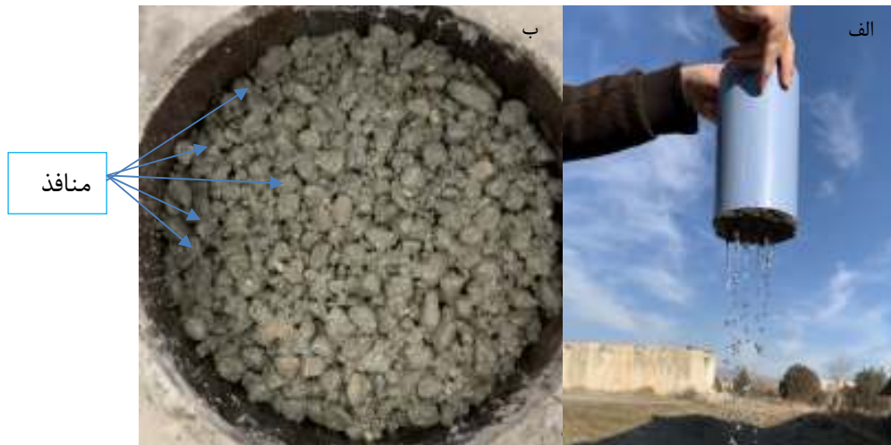
شکل ۲. الف) قابلیت گذردهی آب نمونه بتنی متخلخل ب) منافذ بتن متخلخل
