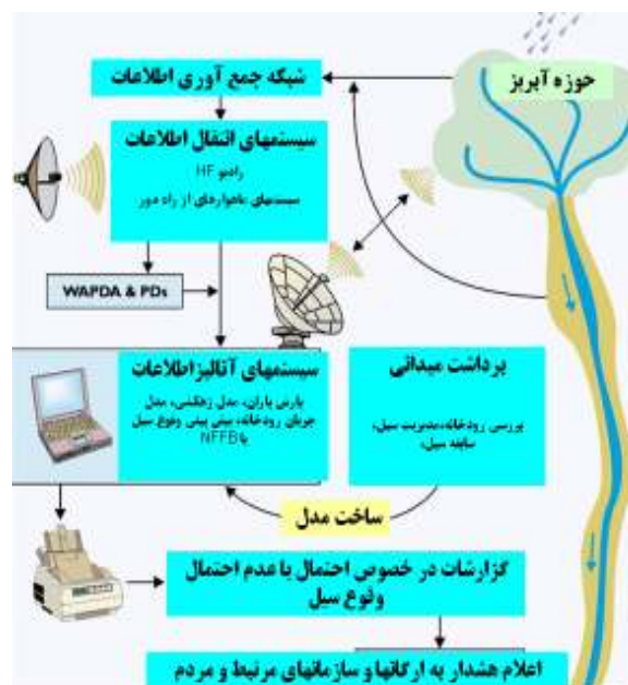
شکل ۴. فرآیند تجهیزات پیش‌آگاهی دهنده وقوع سیل در جاده‌ها (راست)
