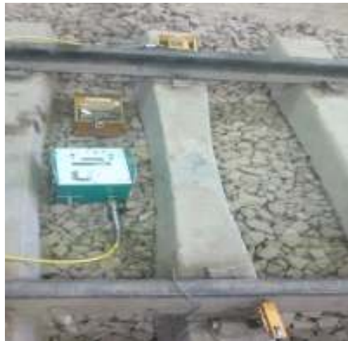
شکل ۵. روند آماده سازی خط (تخلیه بالاست آخوری) برای انجام تست STPT
