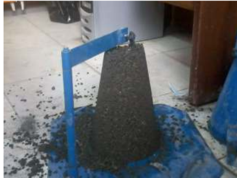
شکل ۱. تصویر آزمایش اسلامپ نمونه بتن نفوذ پذیر حداکثر اندازه سنگدانه ۱۲/۵
