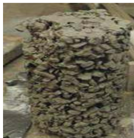
شکل ۳. تصویر نمونه استوانه‌ای ۲۰ در ۱۰ سانتی‌متر بتن نفوذ پذیر با سنگدانه ۱۹/۵ میلی‌متر
