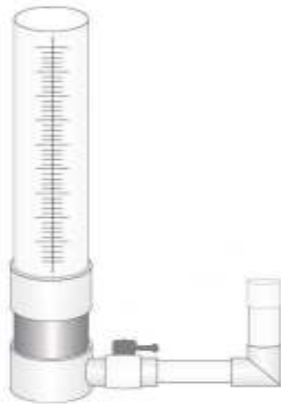
شکل ۲. تصویر وسیله اندازه‌گیری نفوذپذیری نمونه بتن نفوذ پذیر
