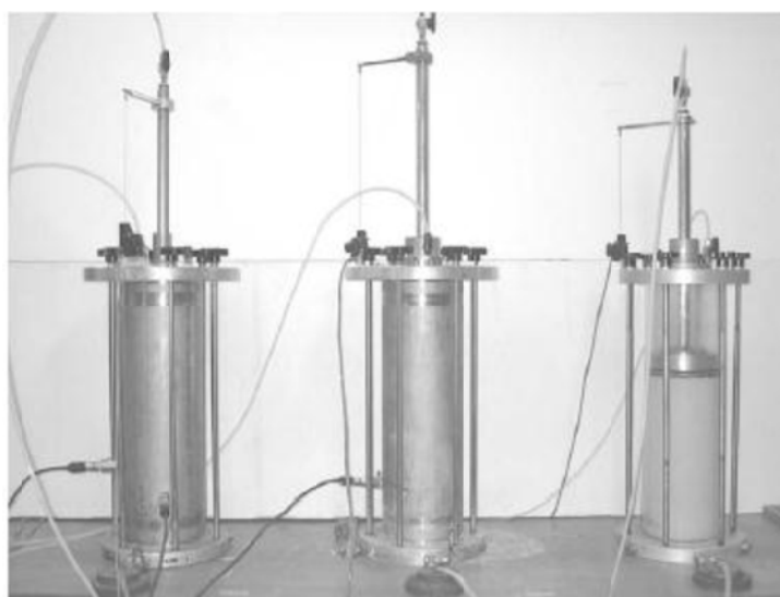
شکل ۱۵. سلول تحکیم توسعه داده شده در حین عمل تحکیم (Gniel and Bouazza, 2009)
