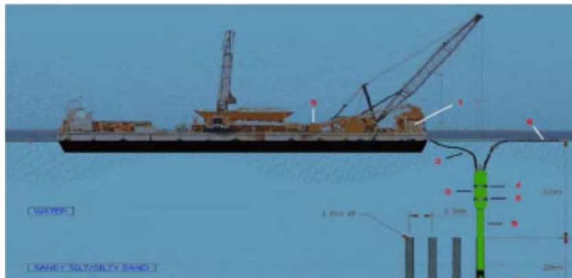
شکل ۶. نحوه اجرای ستون سنگی دریایی (بابازاده، ۱۳۸۹)
