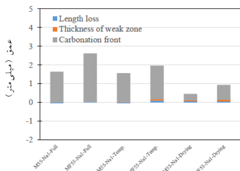
شکل ۲. اثر تغییرات دما و خشک شدن بر عمق تخریب ناشی از حمله سولفات سدیم (SO_4^{2-}, 10000 میلی گرم در لیتر)
