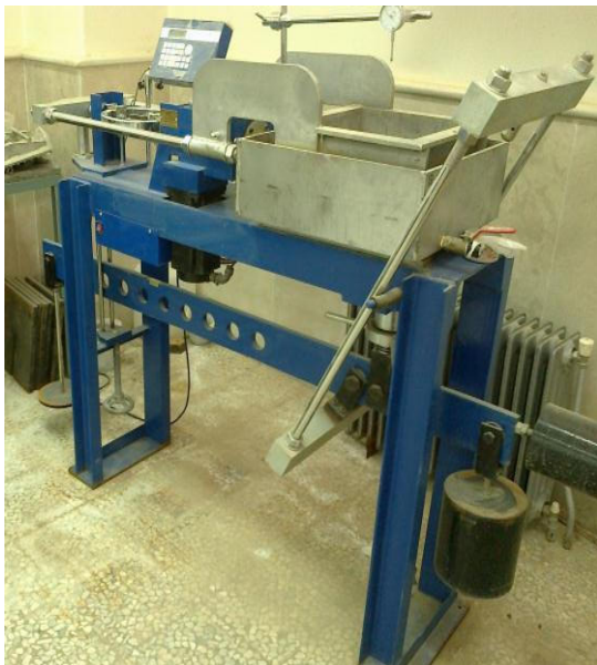
شکل ۳. دستگاه برش مستقیم بزرگ مقیاس استفاده شده در این تحقیق (آزمایشگاه مکانیک خاک دانشگاه زنجان)
