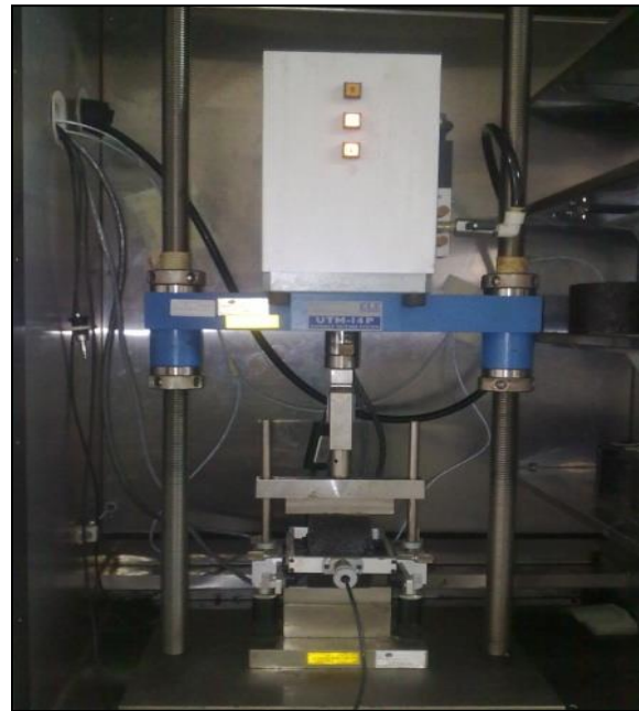
شکل 3. آزمایش کشش غیر مستقیم به منظور تعیین مدول برجهندگی مخلوط آسفالتی
