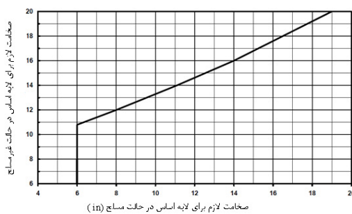
شکل ۷. نمودار وبستر برای تعیین ضخامت لایه مسلح
