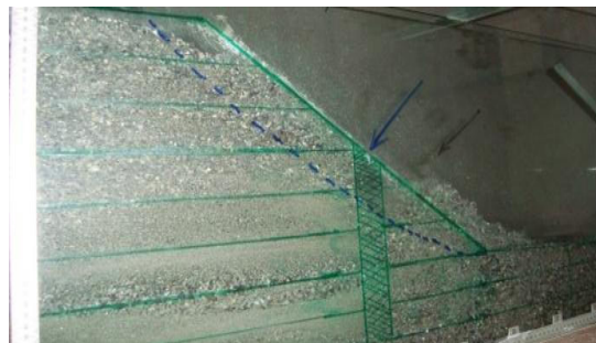
شکل ۷. گسیختگی شیریوانی مسلح با ستون سنگی با ظرفیت باربری ۶/۰۶ کیلو پاسکال
