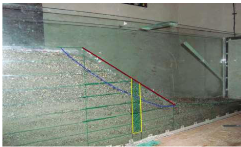
شکل ۱۵. گسیختگی شیروانی مسلح با ستون سنگی با ظرفیت باربری ۳۳/۰۹ کیلوپاسکال
