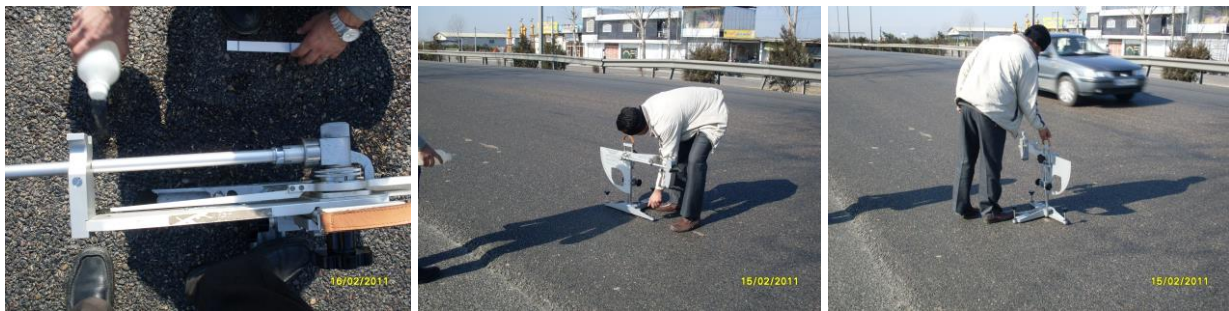
شکل 8. انجام آزمایش پاندول انگلیسی بر روی آسفالت متخلخل و آسفالت معمولی
