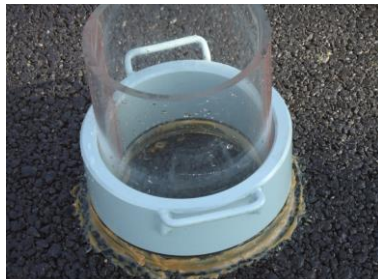
ب- آب‌بندی اطراف دستگاه نفوذپذیرسنج
