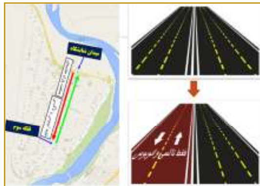
شکل ۹. اجرای خط ویژه در ضلع غربی بلوار شهید چمران
