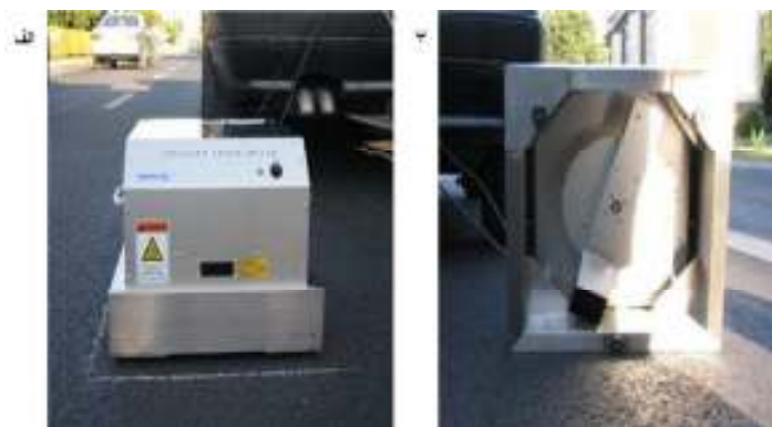
شکل ۳. (الف) دستگاه CTM در حال اندازه‌گیری؛ (ب) مشاهده سنسور لیزر (Henry, J J, 2000)
