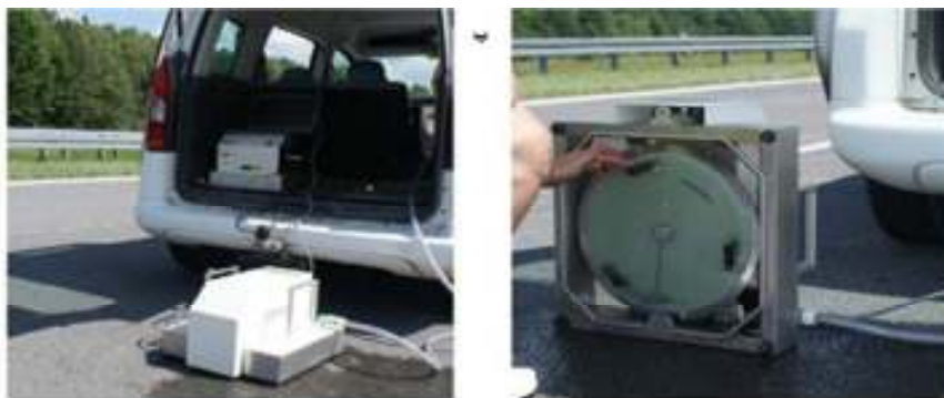
شکل ۲. الف) دستگاه DFT در حال اندازه‌گیری؛ ب) مشاهده دیسک با لغزنده‌های لاستیکی (Wasilewska. M. a, 2016)
