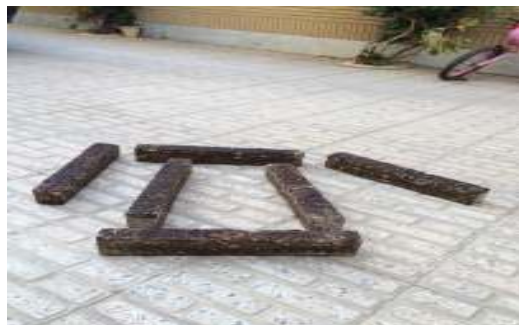
شکل ۲. نمونه تیرهای آسفالتی آماده شده برای آزمون خستگی
