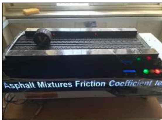
شکل ۲. دستگاه تعیین ضریب اصطکاک لغزشی نمونه‌های استوانه‌ای آسفالتی
