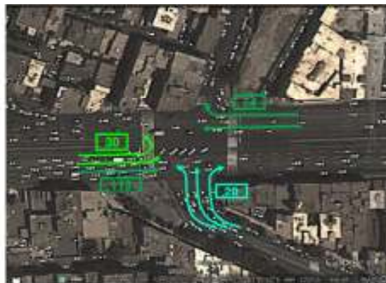
شکل ۲. حرکات ترافیکی به همراه زمان بندی چراغ راهنمایی
