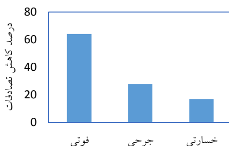
شکل ۲. نمودار میزان کاهش تصادفات در اثر استفاده از سامانه روشنایی در جاده‌ها
