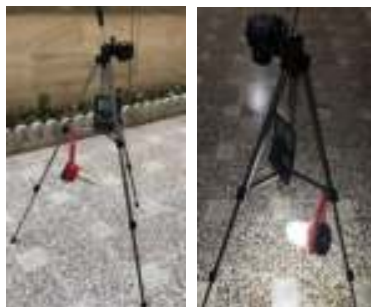
شکل ۷. سخت‌افزار برداشت تصاویر خرابی روسازی آسفالتی
