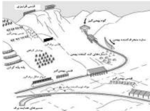
شکل ۸. جانمایی فنس، گالری، دیوار و پوشش گیاهی (Kloow and Jenstav, 2011)
