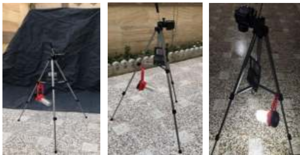
شکل ۱. سخت‌افزار برداشت تصاویر خرابی روسازی آسفالتی در شرایط کنترل شده
