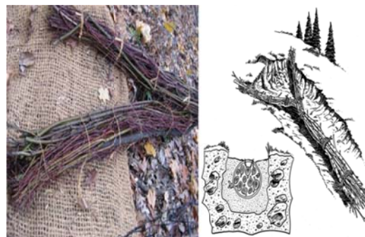
شکل ۱. دیواره گهواره‌ای زنده Timber Crib
