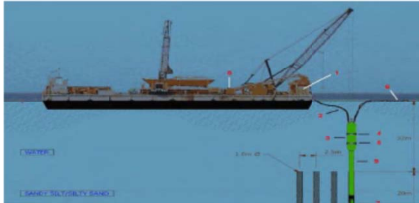
شکل ۶. نحوه اجرای ستون سنگی دریایی (بابازاده، ۱۳۸۹)
