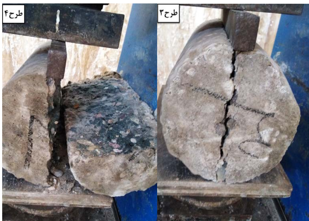
شکل ۳. نمونه‌های بتنی حاوی نانوسیلیس در آزمون مقاومت کششی
