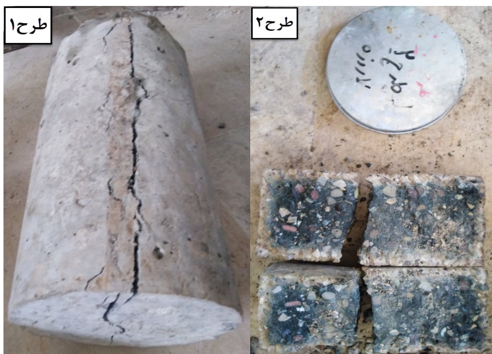
شکل ۲. نمونه بتنی فاقد نانوسیلیس در آزمون مقاومت کششی
