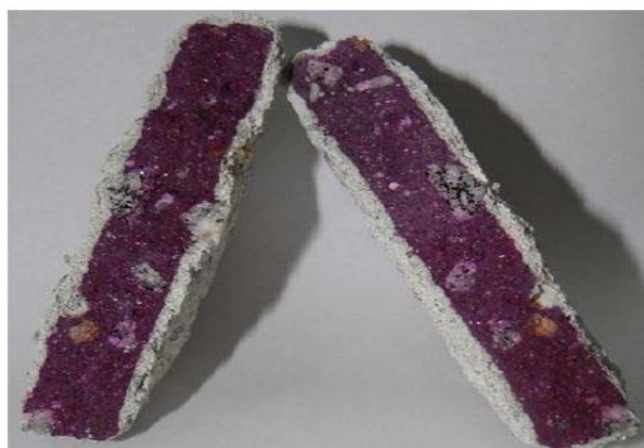
شکل ۸ نمونه های بتنی پس از اسپری کردن فنل فتالین (Torres, De Souza, et al., 2019)
