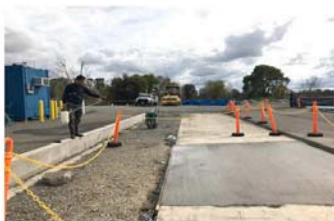
شکل ۸. روسازی بتنی حاوی حسگرهای پیزو-مقاومتی (Gupta et al., 2021)
