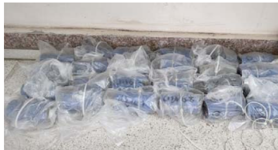
شکل ۶. عمل‌آوری نمونه‌ها در محیط آزمایشگاه
