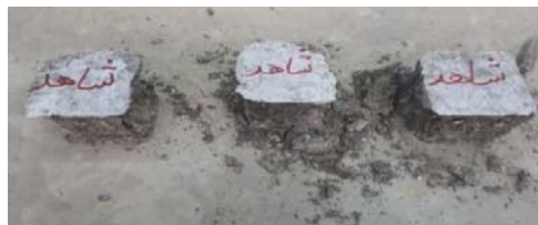
شکل ۱. نمونه‌های بتن بعد از آزمون مقاومت فشاری
