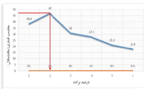
شکل ۳. خط برازش و معادله خط مربوط به اثر براده آهن بر روی مقاومت فشاری
