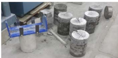
شکل ۴. نمونه‌ها بعد از آزمایش کششی غیرمستقیم
