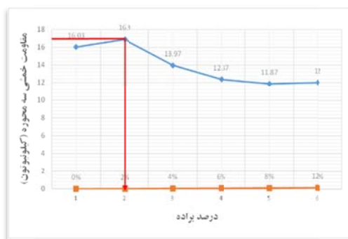
شکل ۸. اثر براده آهن بر روی مقاومت خمشی سه محوری
