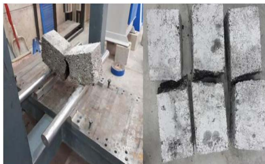
شکل ۷. نمونه‌ها در حین آزمایش و بعد از آزمایش خمشی سه محوری
