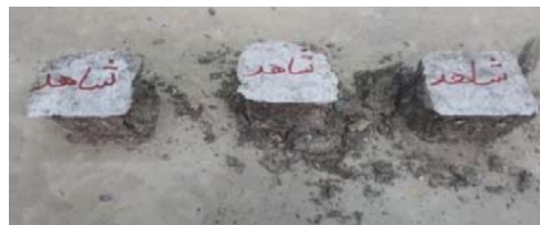
شکل ۱. نمونه‌های بتن بعد از آزمون مقاومت فشاری
