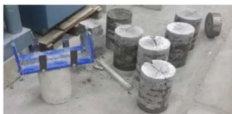
شکل ۴. نمونه‌ها بعد از آزمایش کششی غیرمستقیم
