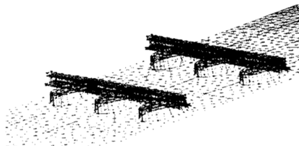
شکل ۴. نمونه مش بندی دال خط کوهاندار در نرم افزار آی سی ام سی اف دی
