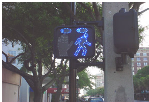
شکل ۲. چراغ‌های الکترونیکی که حضور و جهت حرکت عابر پیاده را مشخص می‌کنند
