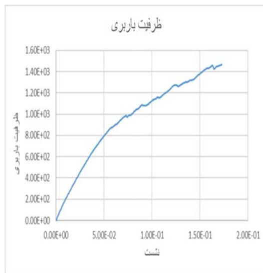
شکل ۴. نمودار ظرفیت باربری نسبت به نشست در خاک مسلح شده یا چهار لایه ژئوگرید
