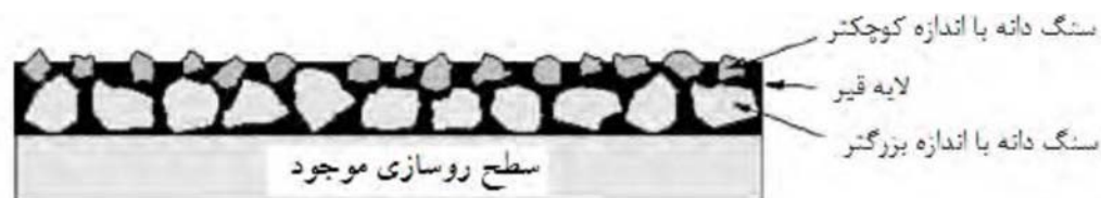
شکل ۱۷. اندود ساندویچی به صورت شماتیک (Arian and Khalkhali, 2017)
