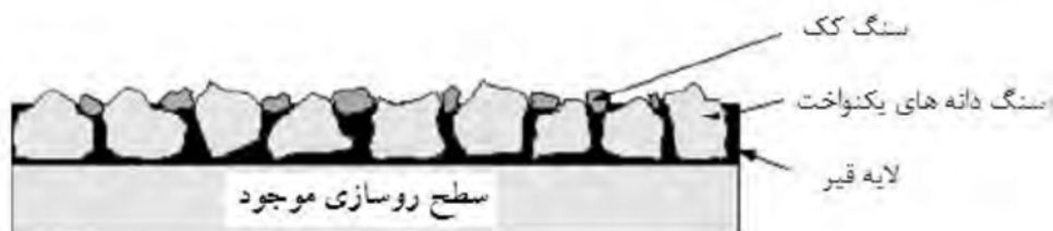
شکل ۱۴. اندود قفل شده به صورت شماتیک (Arian and Khalkhali, 2017)
