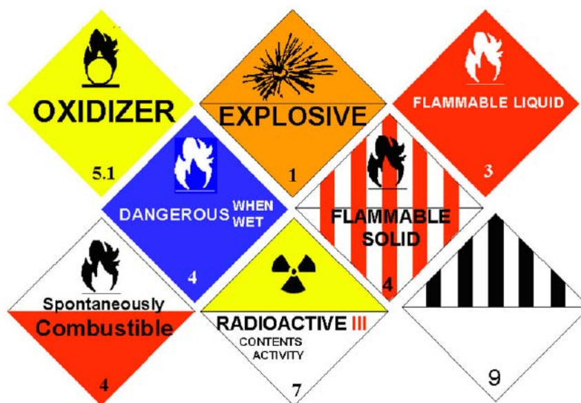
شکل ۸. علائم، نشانه‌ها و تابلوهای مرتبط با کالاهای خطرناک در شبکه ریلی آمریکا (منبع: US DOT)
