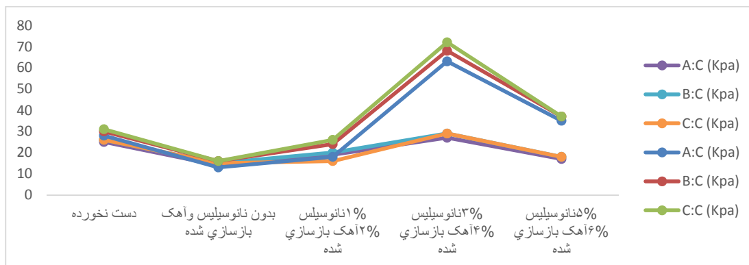
شکل ۱۱. مقایسه مقادیر چسبندگی میکروسیلیس-آهک و میکروسیلیس (بدون آهک)
