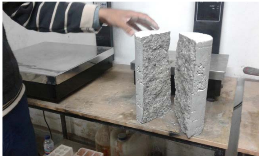
شکل ۴. نمونه استوانه‌ای دو نیم شده
