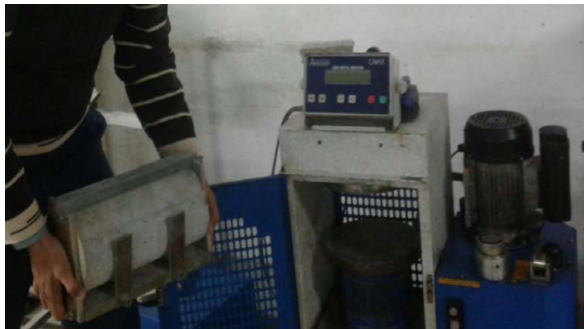
شکل ۳. نحوه انجام آزمایش مقاومت کششی
