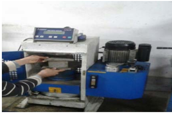
شکل ۵. نحوه انجام آزمایش مقاومت فشاری
