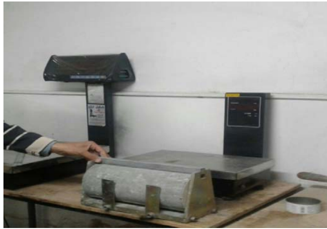
شکل ۲. نحوه قرارگیری نمونه در قالب آزمایش مقاومت کششی
