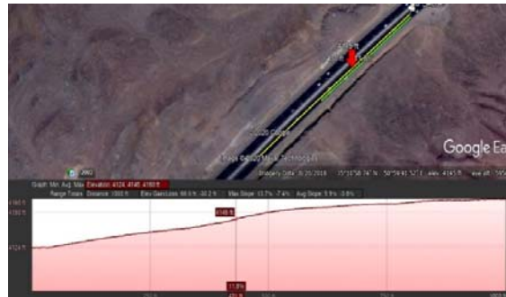
شکل ۱. استفاده از نرم‌افزار گوگل ارث برای به دست آوردن اختلاف ارتفاع بین ۲ نقطه
