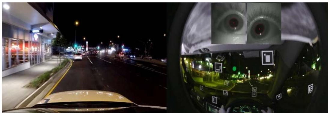
شکل ۲. اندازه‌گیری اندازه مردمک راننده و میزان روشنایی چشم در هنگام رانندگی در امتداد جاده
