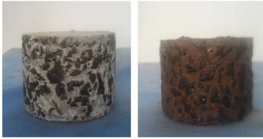
شکل ۱۲. روسازی نیمه انعطاف‌پذیر با دوغاب سیمانی (چپ) و دوغاب سیمانی با قیر امولسیون (راست) (Zarei et al., 2020)
