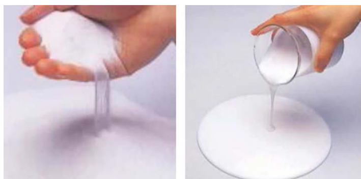
شکل ۱۱. حالت ظاهری اصلاح کننده لاتکس به صورت پودر خشک و ژل (Luo et al., 2020)
